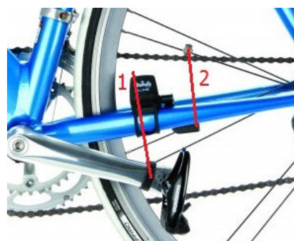
Obr.3 Pozícia senzora voči magnetu: 1. senzor kadencie + magnet 2. senzor rýchlosti + magnet
